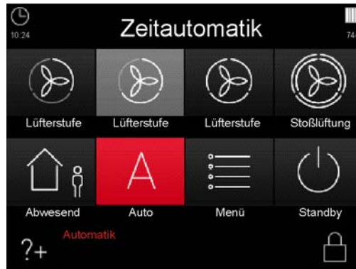
Abb. 8: Automatik-Modus Zeitautomatik mit aktiver Lüfterstufe LS2
