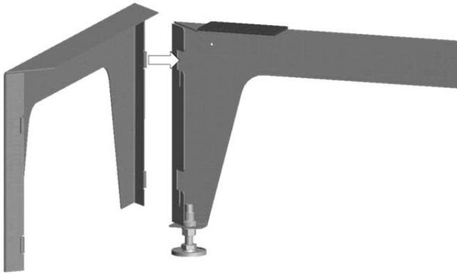
Abb. 20: Aneinandersetzen der Fußteile
