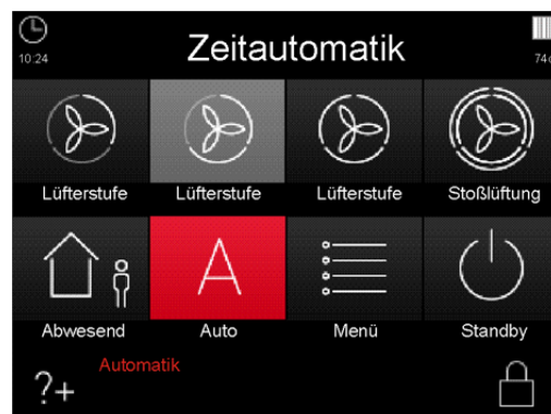
Abb. 11: Automatik-Modus Zeitautomatik mit aktiver Lüfterstufe LS2
