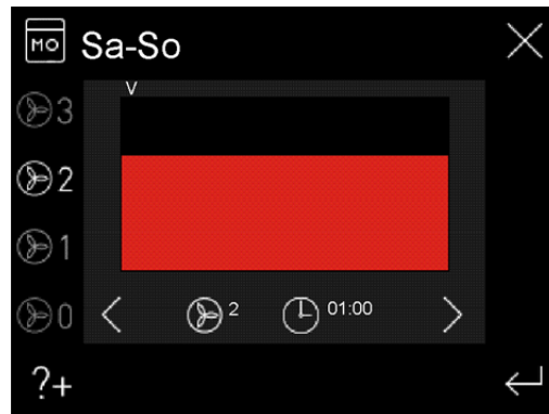
Abb. 10: Zeitautomatik Werkseinstellung, Gruppe Wochentage Sa-So
