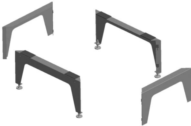
Abb. 23: Einzelteile des Montagerahmens
